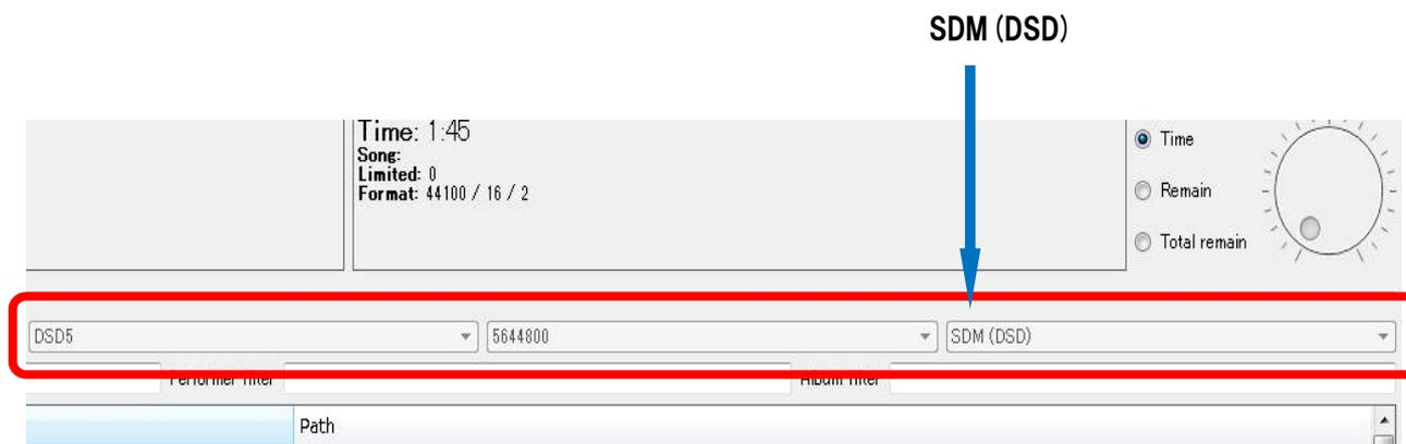
この設定で WAV (192 kHz まで)、FLAC (192 kHz まで) の音楽データを DSD128 に変換しながら AX-D1 で DSD 再生することができます。
